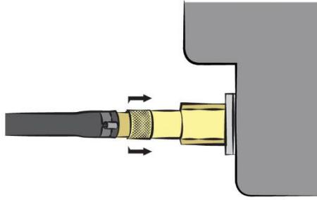
4. Pour vérifier que le tuyau de vapeur est bien raccordé, tirez sur le tuyau. Vérifiez que le tuyau n'est pas entortillé ou pincé.
