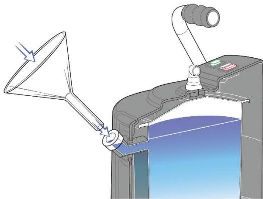
4. Versez avec précaution jusqu'à 8 litres d'eau claire du robinet dans le générateur de vapeur. Si vous traitez par la vapeur une seule balle de foin, nous vous recommandons d'utiliser 6 litres d'eau claire du robinet.
