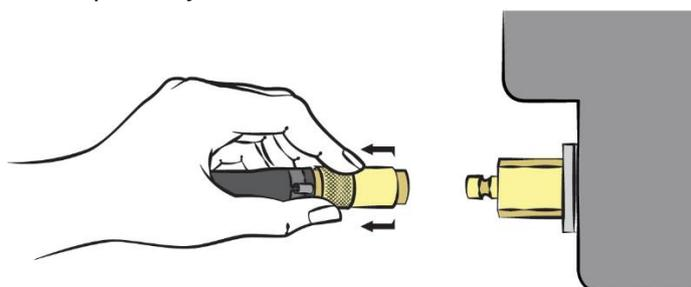
3. Relâchez la bague du raccord rapide sur le tuyau, elle glisse alors en position verrouillée.
